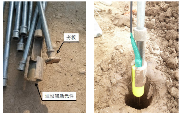
图5 水分计埋设过程中辅助元件
