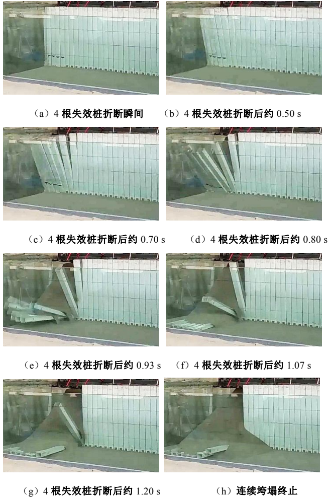
图 11 工况 4 中 4 根桩失效后引发连续垮塌过程
