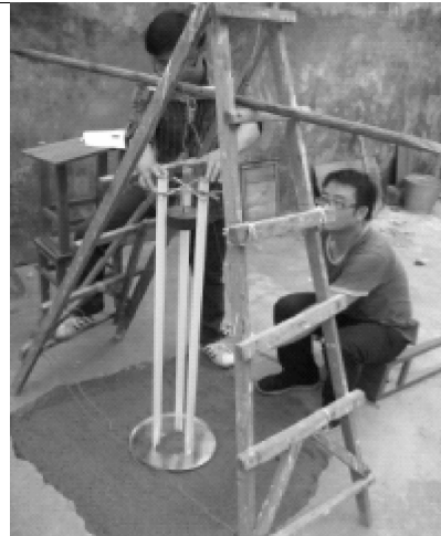
图2 强夯模型试验支架
