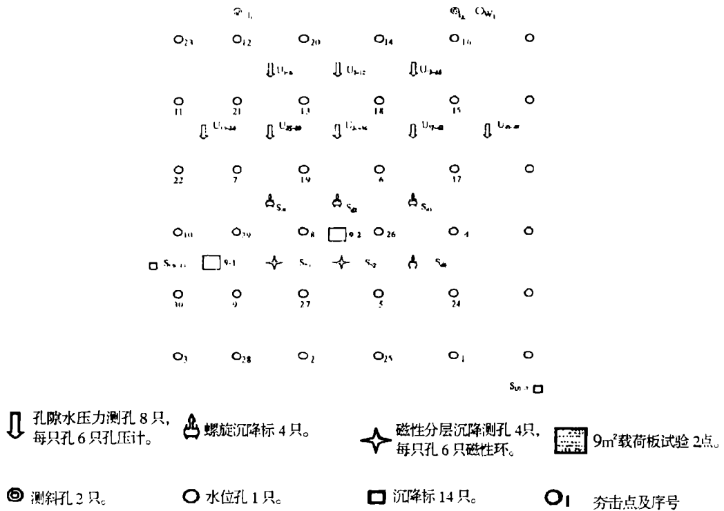
图 1 强夯试验区监测项目及夯序布置图
