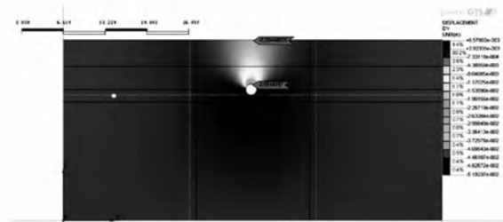
图5 顶管隧道开挖后Y方向位移云图
