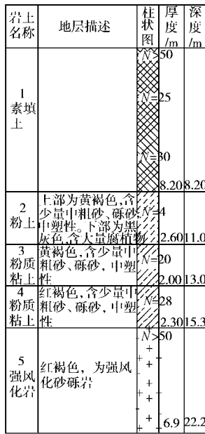
图 1 10000 kN·m 试验区钻孔柱状图
