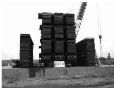
图 2 堆载 21 000 kN 时现场照片
