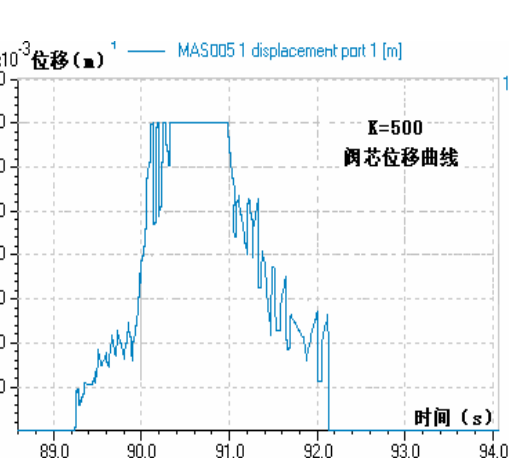
图 8 K=500\text{N/m} 阀芯位移曲线 Fig8 K=500\text{N/m} Spool displacement curve
